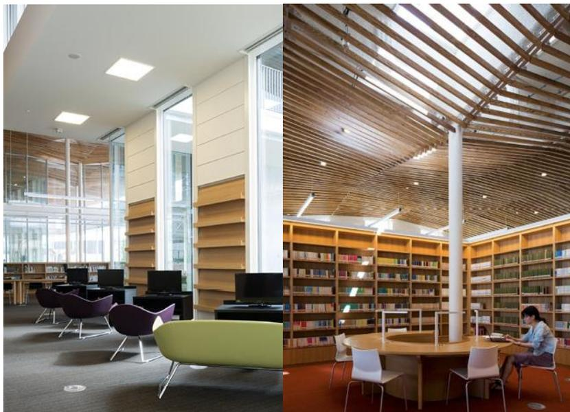
図 10 : 書棚を兼ねた鋼板耐震壁 図 11 : 木漏れ日のような光が落ちるハイサイドライト
